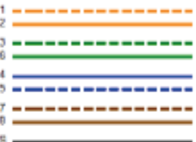
Schéma de câblage (T568B)
